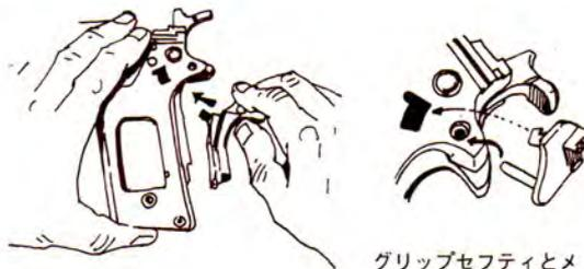
シアー Spring の右端の短い部分を、グリップセフティで押すようにしながら、グリップセフティをメインフレームに取り付ける。
