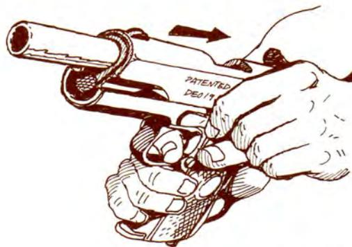
紙火薬を詰めたカートリッジをマガジンに装填する。マガジンを入れたら静かにスライドカバーを引き、初弾をチャンバーに送り込む。後はトリガーを引くと発火します。
