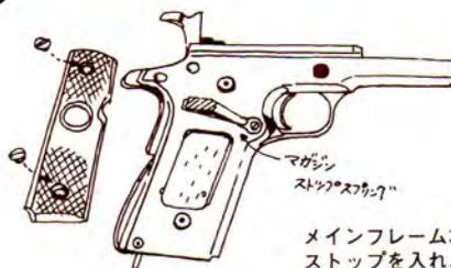
メインフレーム右側よりマガジンストップを入れ、メインフレームのミゾに合せてマガジンキャッチ Spring をかぶせる。グリップを付け終わったら、マガジンストップが動くことを確かめておく。
