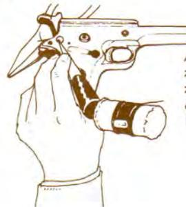
ハンマーピン、シアーピンを図のようにピンポンチ等で抜く。ハンマーピンは必ず右側から叩き左へ抜く。2本のピンを抜き取ると、ハンマー、シアー、ディスコネクター、トリガーが取り出せます。
