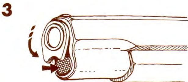
3 レコイルスプリングにレコイルプラグをかぶせ、指で押し込みながらトップリングを入れる。そのまま矢印方向に廻してレコイルプラグの指をはなし、トップリングにかみ合せる。
