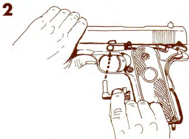
2 スライドカバーの横の半月形の凹と、クリックピンの先端が合う所迄スライドカバーをさげ、そのままスライドストップをはめ込む。クリックピンが当って入りにくい時は、ドライバー等でクリックピンを押し込んで入れて下さい。
