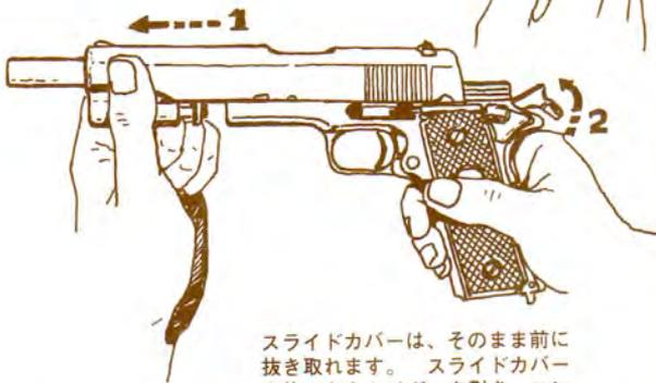
スライドカバーは、そのまま前に抜き取れます。スライドカバーを抜いたらトリガーを引き、ハンマーは必ず落しておいて下さい。
