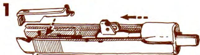
1 バレルをスライドカバーの前からさし込みます。レコイルガイドにレコイルスプリングを通して、半月形の方をバレルにそわせてセットします。ファイアリングプレートはスライドカバーにきちんとはめ込んで下さい。
