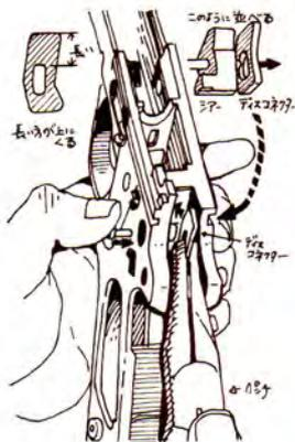
② 初めて組立てる方はトリガーを引きすぎてパーツ等を変形させることがあるので、この段階で「8」のマガジンキャッチと右側グリップの組立を行っておくと良い。
