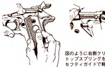
図のように右側クリックピンと、セフティストップ Spring をメインフレームに乗せ、セフティガイドで軽く押え左側クリックピンを入れる。飛び出さないように注意しながらセフティガイドを押え、左側のグリップを取り付ける。
