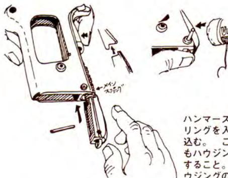
ハンマーストラットにメイン Spring を入れ、ハウジングで押し込む。この時グリップセフティもハウジングで押えられるようにすること。メインフレームとハウジングの穴が合ったら、2.5ミリピンを打ち込んで止める。
