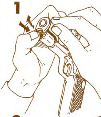
レコイルプラグを指で押し込み、トップリングを矢印の方向へ半回転させて前に抜き取る。レコイルプラグは、レコイルスプリングの力で飛び出すので、注意しながら取り出して下さい。サムセフティをにかけていないと、スライドカバーが動いて分解しにくいので必ずかけておくこと。
