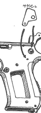
サブプレートの太い穴はハンマーピンに、細い穴はシースプリングピンにそれぞれ合せる。ピッタリ合っていないと、スライドがサブプレートにあたり、動かなくなることがあるので良く注意して取り付けること。
